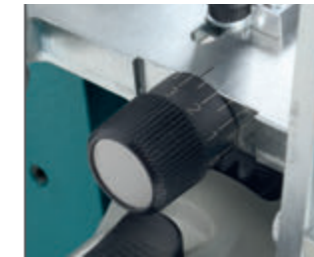
Réglage micrométrique de la position du moteur
