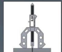
Messung einer Schweißnaht /
