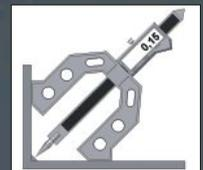
Messung einer Schweißnaht 45° /
