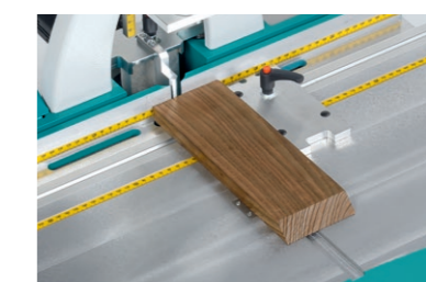
Paralela direita com régua graduada de ajuste integrado
