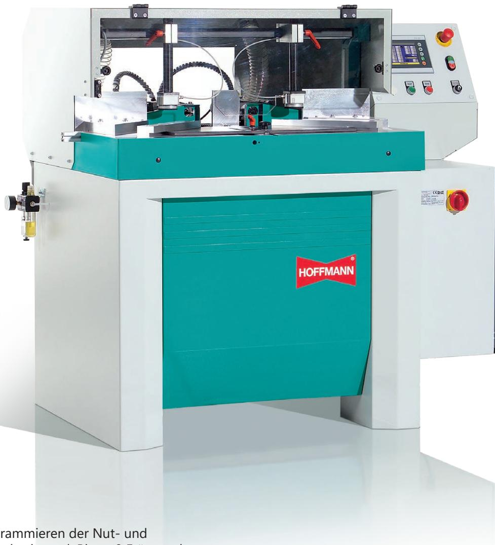
Variables Programmieren der Nut- und Bohrpositionen horizontal. Bis zu 9 Fräs- und Bohrpositionen frei programmierbar. Zum Herstellen von Gehrungseckverbindungen bei Holzprofilen oder Werkstücken aus Kunststoffarten.
