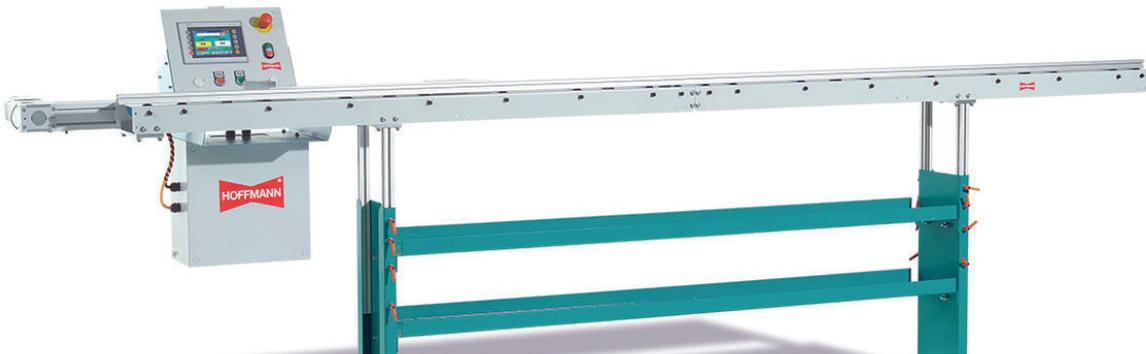
Automatischer Längenanschlag als Positionier- und Anschlagssystem zum Anbau an Säge-, Fräs- und Bohrmaschinen, auch marktgängige Fremdfabrikate. Schnellere Teilepositionierung und höhere Präzision für die Bearbeitungen = geringere Fehlerquote und weniger Ausschussteile. Stabiler Grundkörper, kräftige Rollenbahn mit materialschonender Verkleidung, hochwertiger Kugelumlauftrieb für ruhigen, ruckfreien Lauf des Positionierschlittens.
