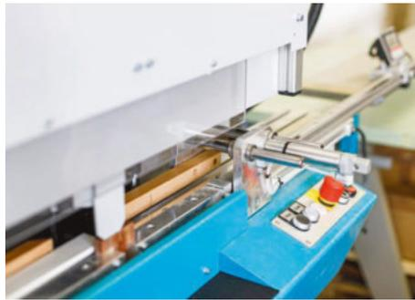
*/ In die Schnittflächen eingefräste Keilnuten ermöglichen eine formschlüssige Konstruktionsverbindung.*
