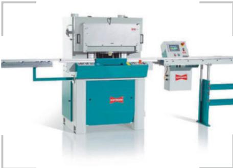
*/ Das Doppelsägeaggregat schneidet die Gehrungen der Rahmenecken präzise und ausrissfrei zu.*
