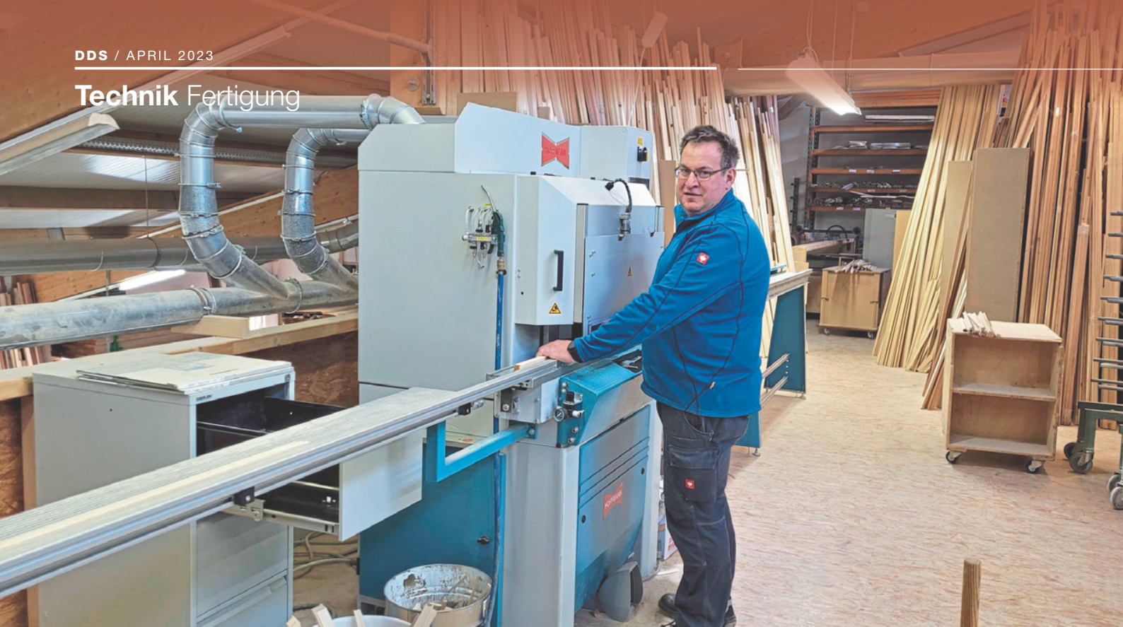
Jochen Zilch bedient seine neue kombinierte, CNC-gesteuerte Doppelgehrungssäge und Fräsmaschine
